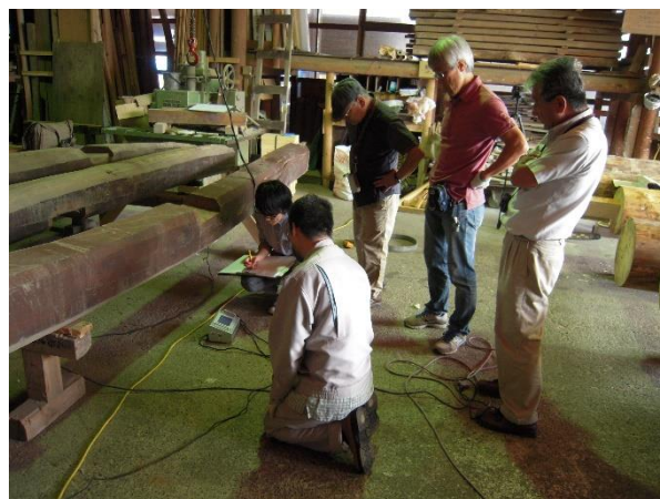
写真 14 非破壊検査による強度測定
