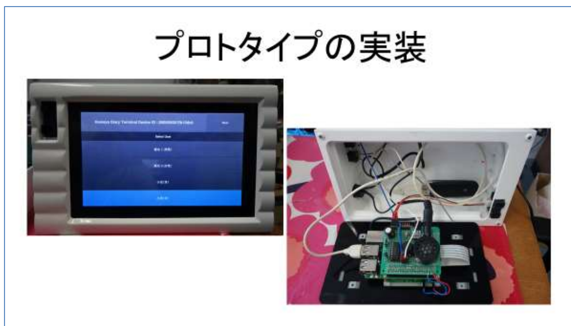
図 3. 組み込み用 Linux を用いた専用端末の実装例
