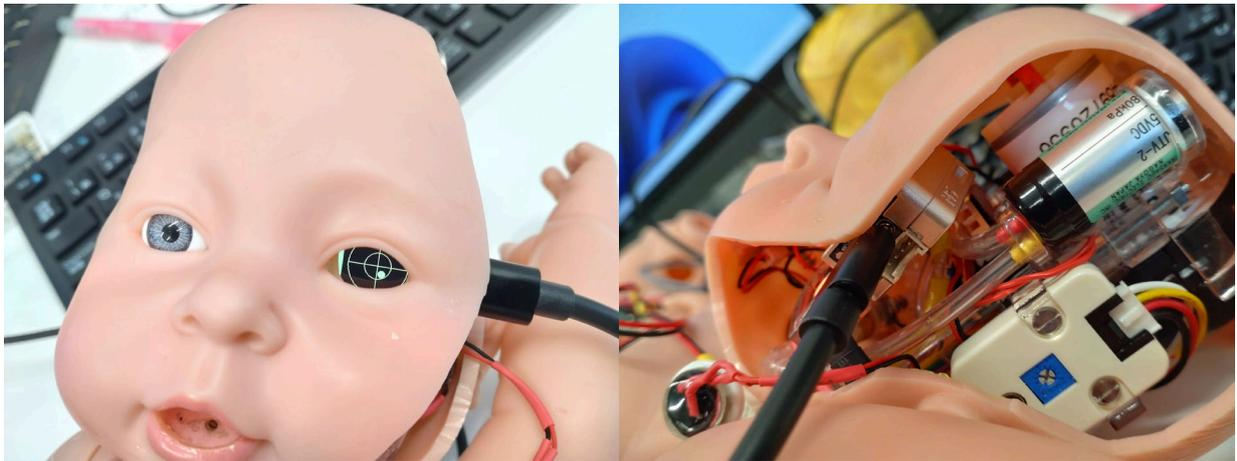
図7:M5 STACK ATOM S3(0.85インチIPS液晶を搭載)を眼球下に配置した図
